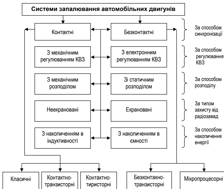
Рис. 1.5. Класифікація систем запалювання автомобільних двигунів [53, 63, 66]
