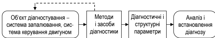
Рис. 1.9. Схема системи діагностування [38]
