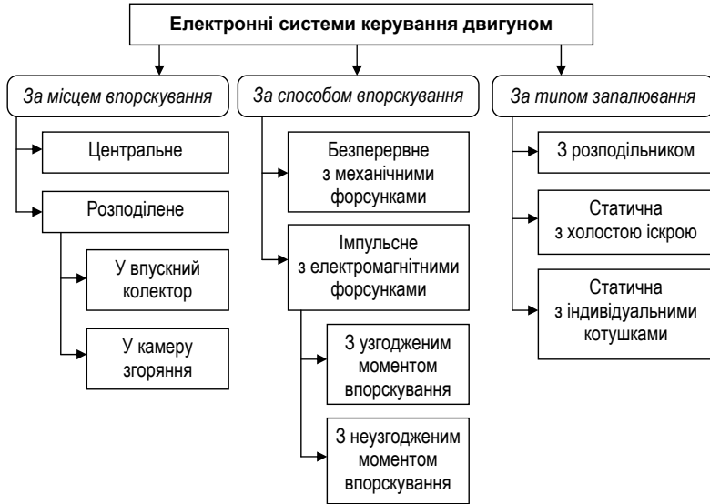
Рис. 1.6. Класифікація електронних систем керування автомобільним двигуном [53, 54]
